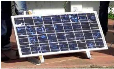
Panneau PW500 utilisé avec diodes bypass.
