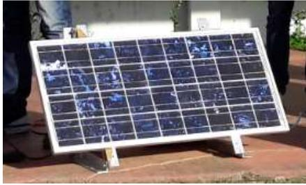
**Figure 7.** Panneau PW500 polycristallin avec 2 diodes bypass amovibles dans la boîte de jonction .
