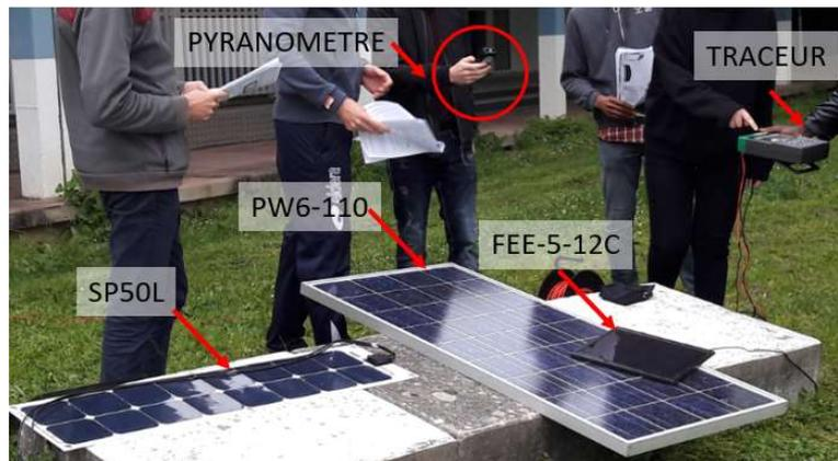
**Figure 6.** Les 3 panneaux utilisés et les dispositifs de test.
