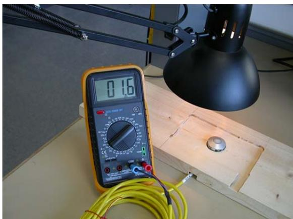
**Photo 3** Etalonnage du "soleil artificiel". Le voltmètre indique l'irradiation vue par le pyranomètre qui est éclairé par la lampe.
