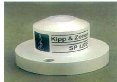
Photo 2 pyranomètre SP-Lite
